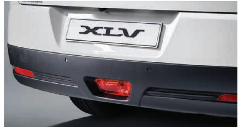
Hintere Stoßstange mit Einparkensensoren und integrierter Nebelschlussleuchte.
