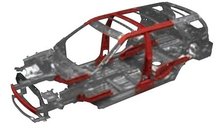
Karosserie aus hochfestem Stahl an 10 Schlüsselpunkten des Rahmens, um die Sicherheit der Insassen weiter zu verbessern.
