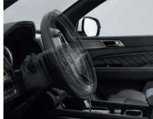
Höhen- und längsverstellbares Lenkrad
