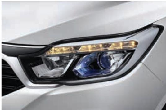
Scheinwerfer mit HID-Technologie (High Intensity Discharge) für optimale Nachtsicht, LED-Tagfahrleuchten, Positionsluchten und Fahrtrichtungsanzeiger im Scheinwerfergehäuse schaffen einen klaren und eleganten Charakter.
