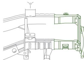
Bei einem Frontalaufprall überträgt der Teil des Rahmens, der sich am meisten verformt, den größten Teil der Aufprallenergie in den Innenraum. Der Rexton verfügt über eine Verformungszone, die speziell zur Dämpfung des Aufpralls und für die Sicherheit der Fahrgäste ausgelegt ist (Crash-Zone-Box mit dritter Lastlinie).
