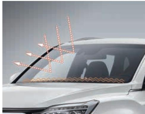
Komfort-Windschutzscheibe mit Solar- und Lärmschutzfunktion und Scheibenwischerentfroster
