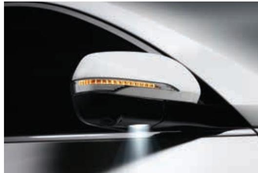
Außenspiegel mit integrierten Fahrtrichtungsanzeigern und Türleuchten
