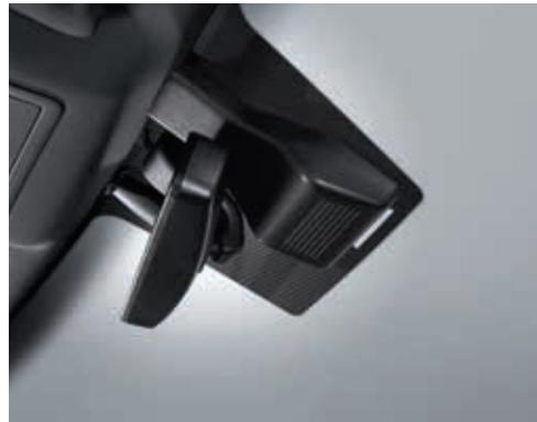
Frontkamera mit automatischer Aktivierung von Scheinwerfern und Scheibenwischern
