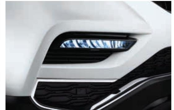
Nebelscheinwerfer mit integriertem LED-Abbiegelicht
