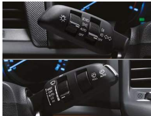
Scheinwerfersteuerung mit Lichtsensor und Scheibenwischersteuerung mit Regensensor
