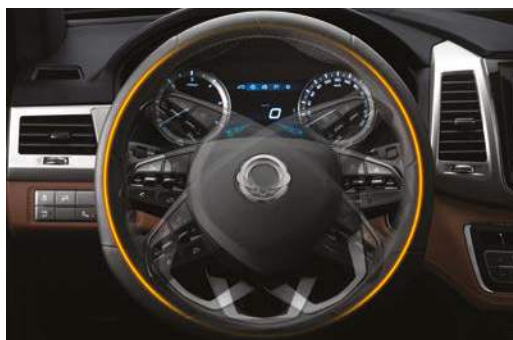
Elektrische, geschwindigkeitsabhängige Servolenkung und beheiztes Lenkrad (Serie ab Ausstattung Dream)
