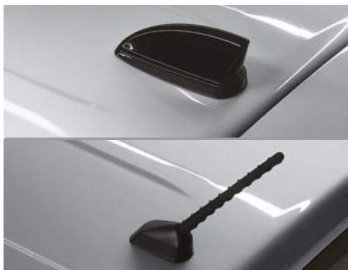
Shark-Fin-Antenne (Serie ab Ausstattung Road) bzw. Stabantenne (Ausstattung Work)
