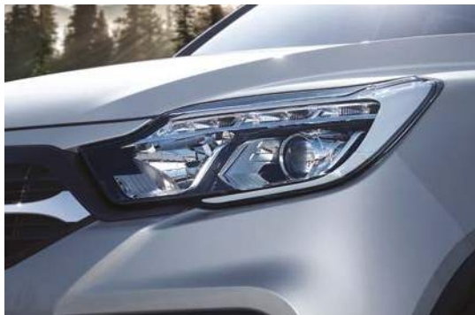
Scheinwerfer mit Xenon-Technologie (Serie ab Ausstattung Dream) für optimale Nachtsicht, LED-Tagfahrleuchten, Positionsleuchten und Fahrtrichtungsanzeiger im Scheinwerfergehäuse
