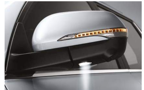
Außenspiegel mit integrierten LED-Fahrtrichtungsanzeigern und Türleuchten
