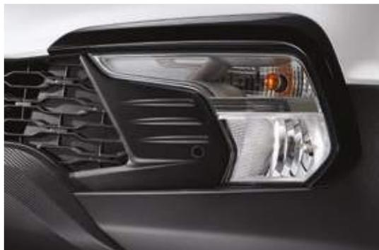
Nebelscheinwerfer mit integriertem Blinker
