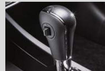
Auswahlschalter für manuelles Schalten (bei Automatikgetriebe)
