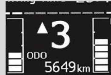
Schaltpunktanzeige (bei Schaltgetriebe)
